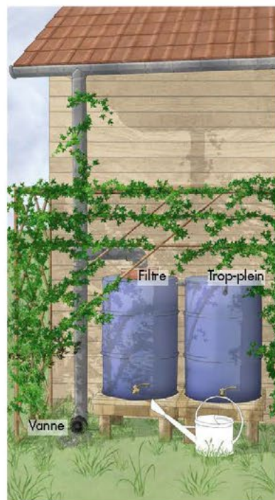
Système de récolte des eaux du toit avec séparation des eaux troubles.
