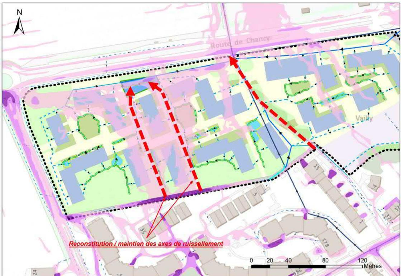
Figure 18 - Intégration d'axes de ruissellement de surface
