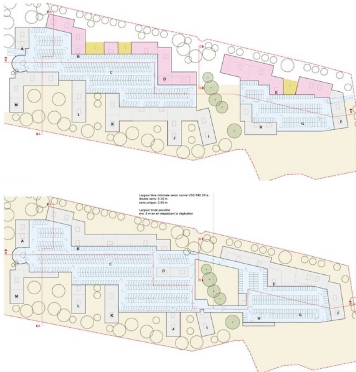
Fig. 84 Principes d'organisation du parking souterrain sur 2 emprises séparées et sur 2 niveaux, étude de faisabilité
