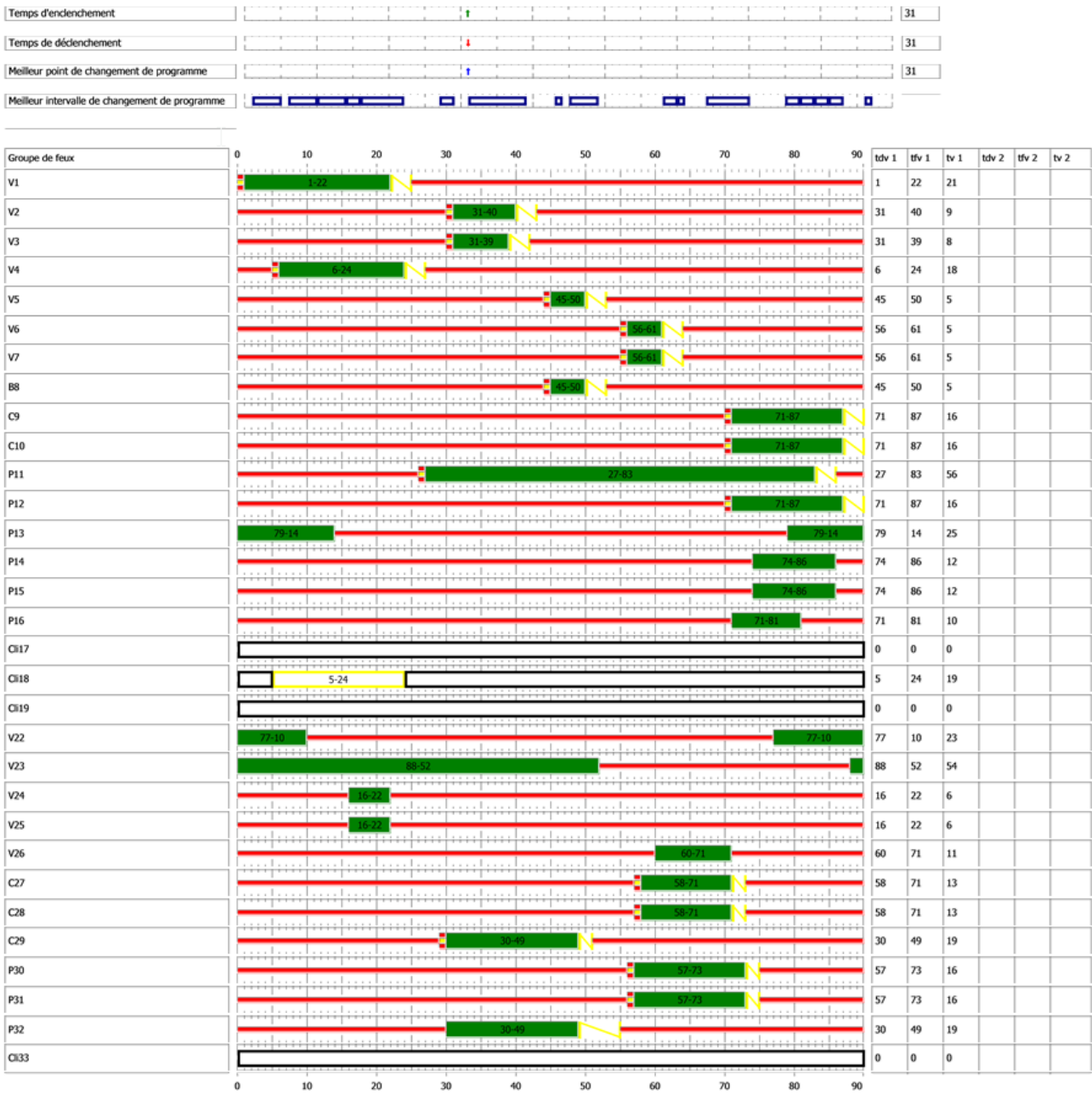
Figure 68 – Plan de feux de secours Abarois – Rouettes / Grouet HPS
