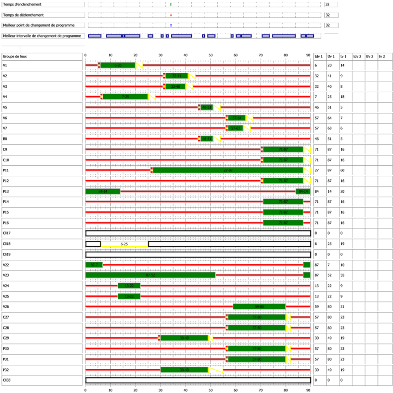
Figure 67 – Plan de feux de secours Abarois – Rouettes / Grouet HPM
