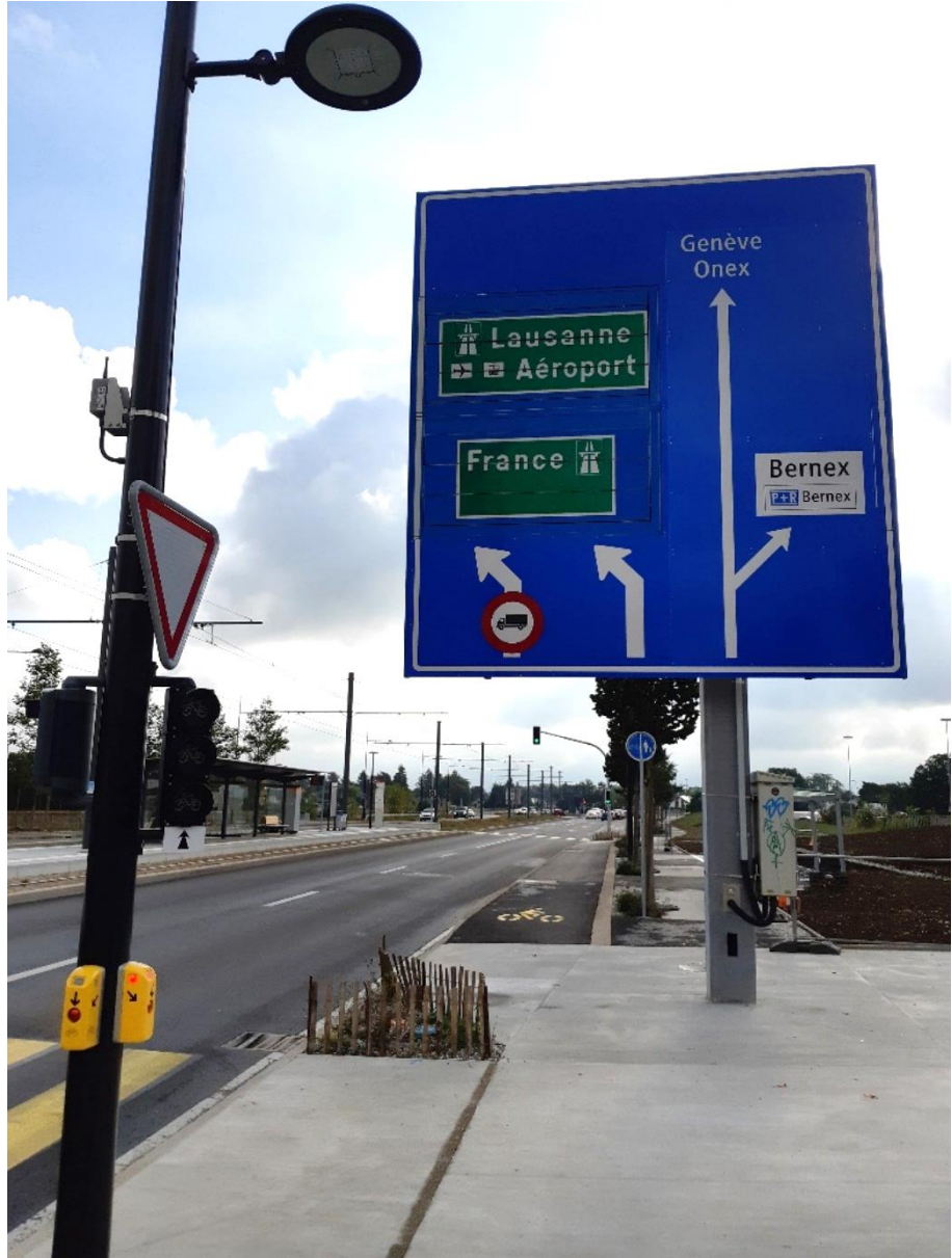
Figure 28 – Panneau de direction à indications variables implanté sur la branche E du carrefour rte de Chancy / Bretelle N01 / rue de Bernex. Septembre 2021.
